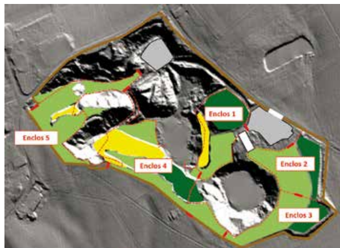
Plan général des travaux sur fond de carte en relief issu d'un modèle numérique de terrain (source: WalOnMap): zones déboisées et délimitation des enclos pour les clôtures
